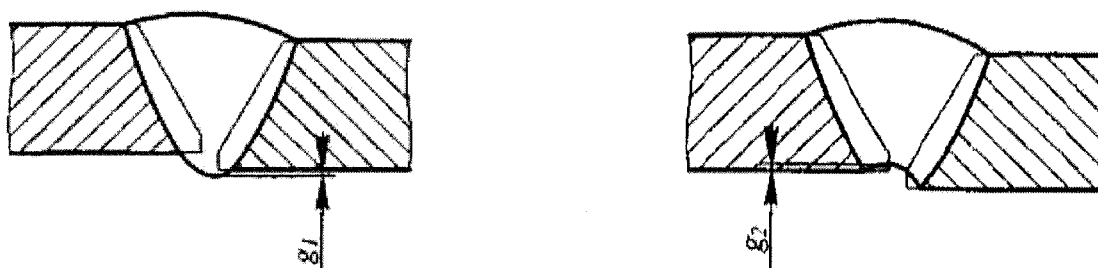
Рис. 7.4. Измерение выпуклости ( g_1 ) и вогнутости ( g_2 ) корня шва стыкового соединения
