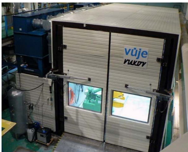
Кесон установки фрагментації (вигляд зовні)
