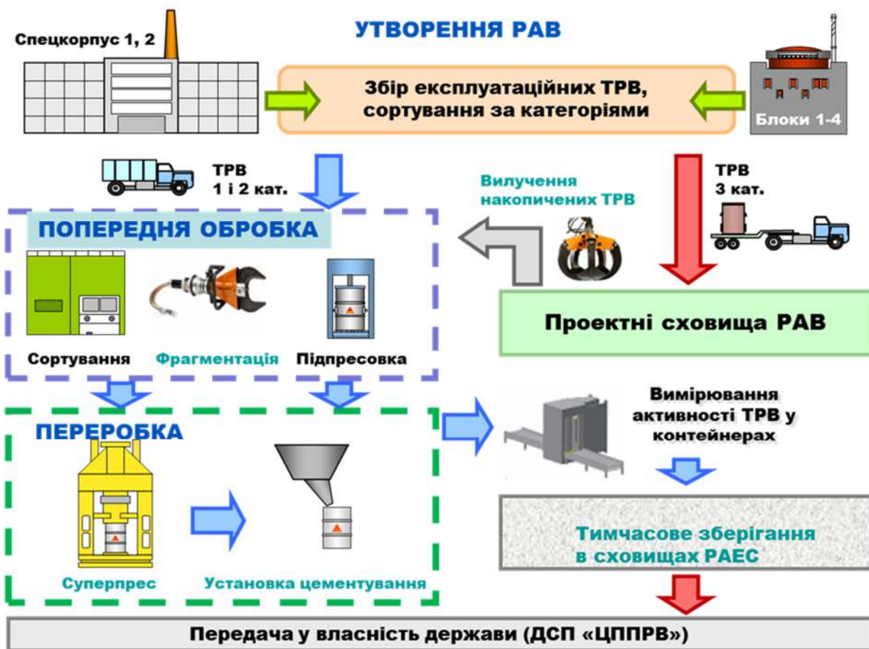
Схема системи поводження з РАВ на РАЕС з упровадженням КПРАВ
