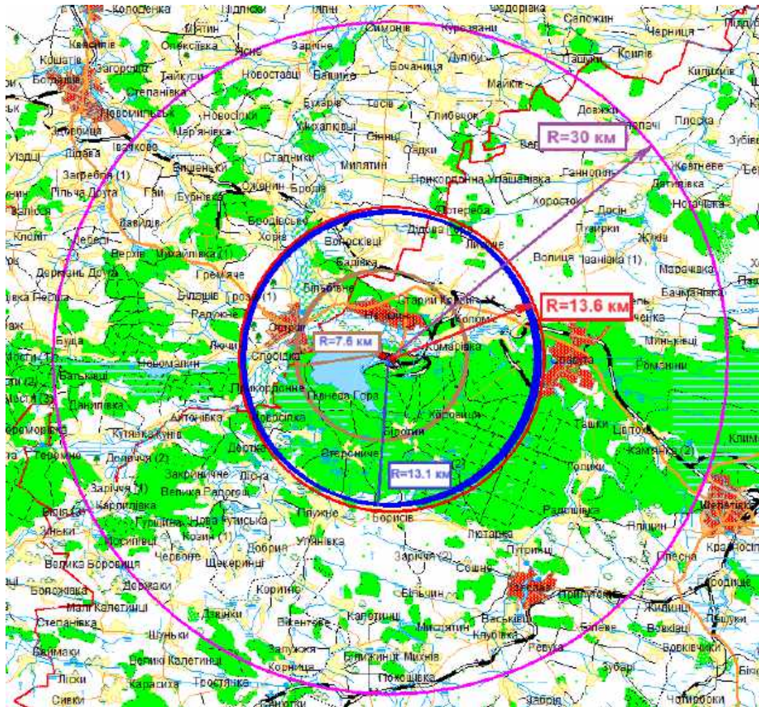
Рисунок 5.16 – Межі зони спостереження Хмельницької АЕС, визначені в результаті проведених розрахунків згідно з вимогами документу НП 306.2.173-2011 (червоним кольором). Фіолетовим кольором показано межу існуючої ЗС ХАЕС у вигляді кола радіусом 30 км.
